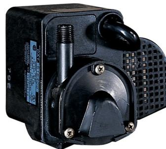
Diese elektrische Tauchpumpe gehört zu einer Baureihe mit vergossener Motorkapsel. Dank der Epoxy Ummantelung sind sie energiesparend und einsetzgerecht konstruiert. Das spezielle Kunststoffgehäuse ermöglicht den Betrieb mit weit verminderter Wärmerwicklung. Die Pumpen sind für Dauerbetrieb geeignet und werden unter anderem zur Zirkulation von Laufbrunnen oder kleinen Gartenteichen eingesetzt.
